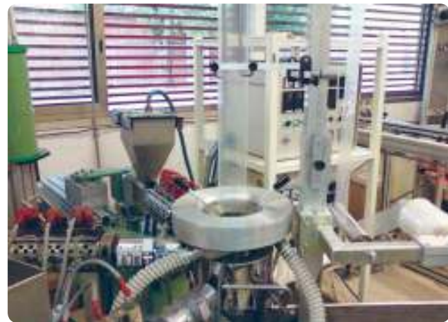
Uno degli impianti di coestruzione per la produzione di film in bolla multistrato, in dotazione al gruppo di Scienza e Tecnologia dei Materiali presso il DII
